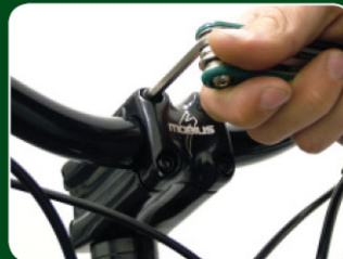
H. Tighten stem cap bolts
